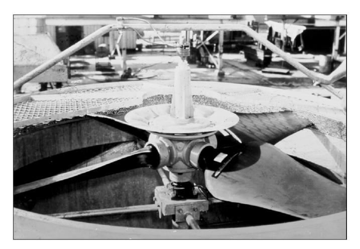
Hudson Auto-Variable<sup>®</sup> Hubs and Tuf-Lite<sup>®</sup> Fan Blades
